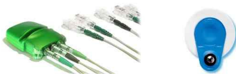
Abbildung 9: EMG Modul des Biofeedbackgeräts 2000 x-pert der Firma Schuhfried und Einwegklebelektrode Blue Sensor M von der Firma Ambu
